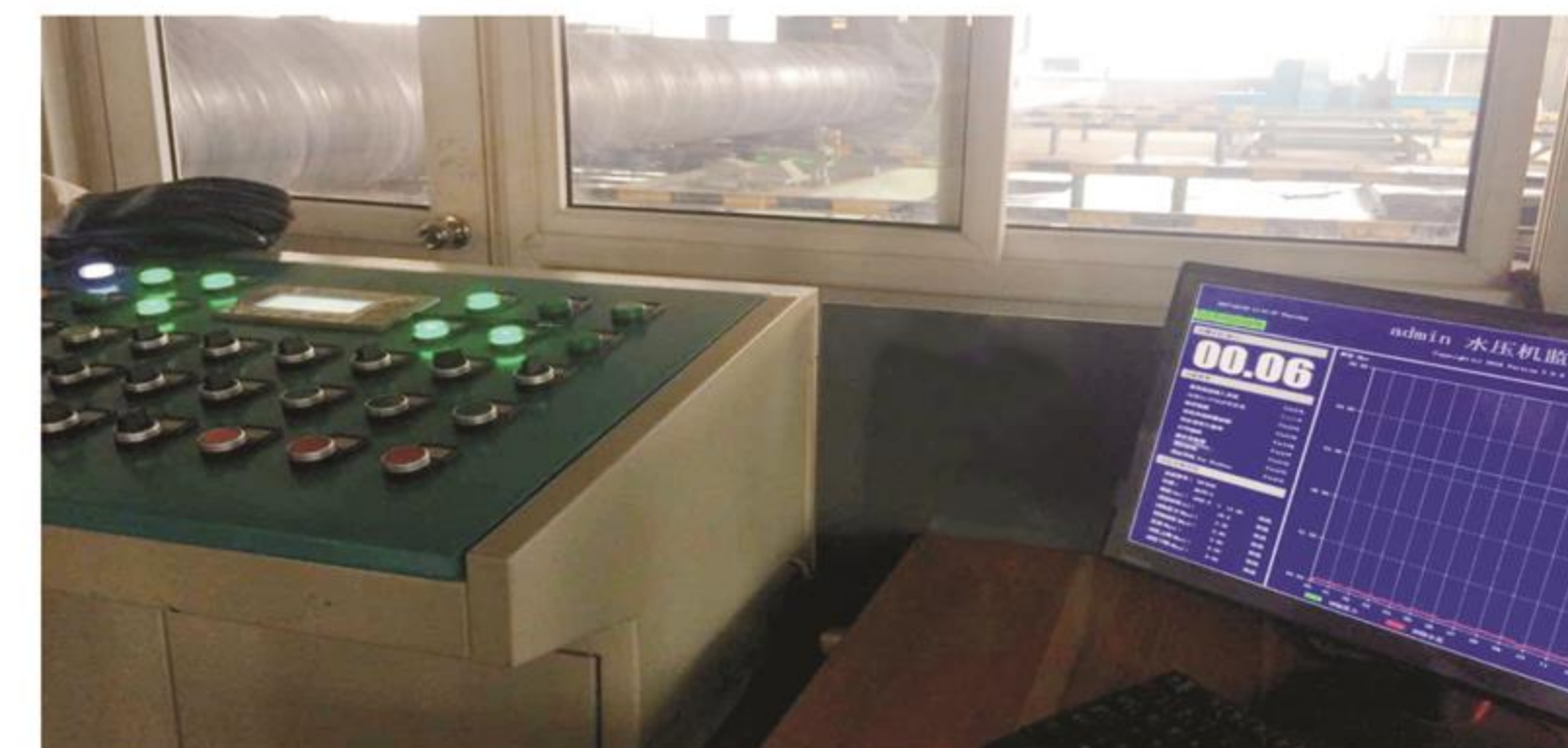
水压测试 Hydraulic Press Testing
